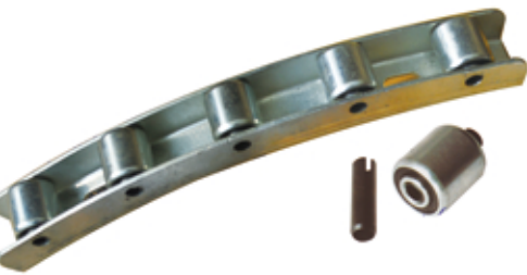
820# 天津OTIS滑轮群5轮 长282 宽35 轮φ26×厚26 轴承G0456销φ10×35 OTIS Pulley Group (5 Rollers)
