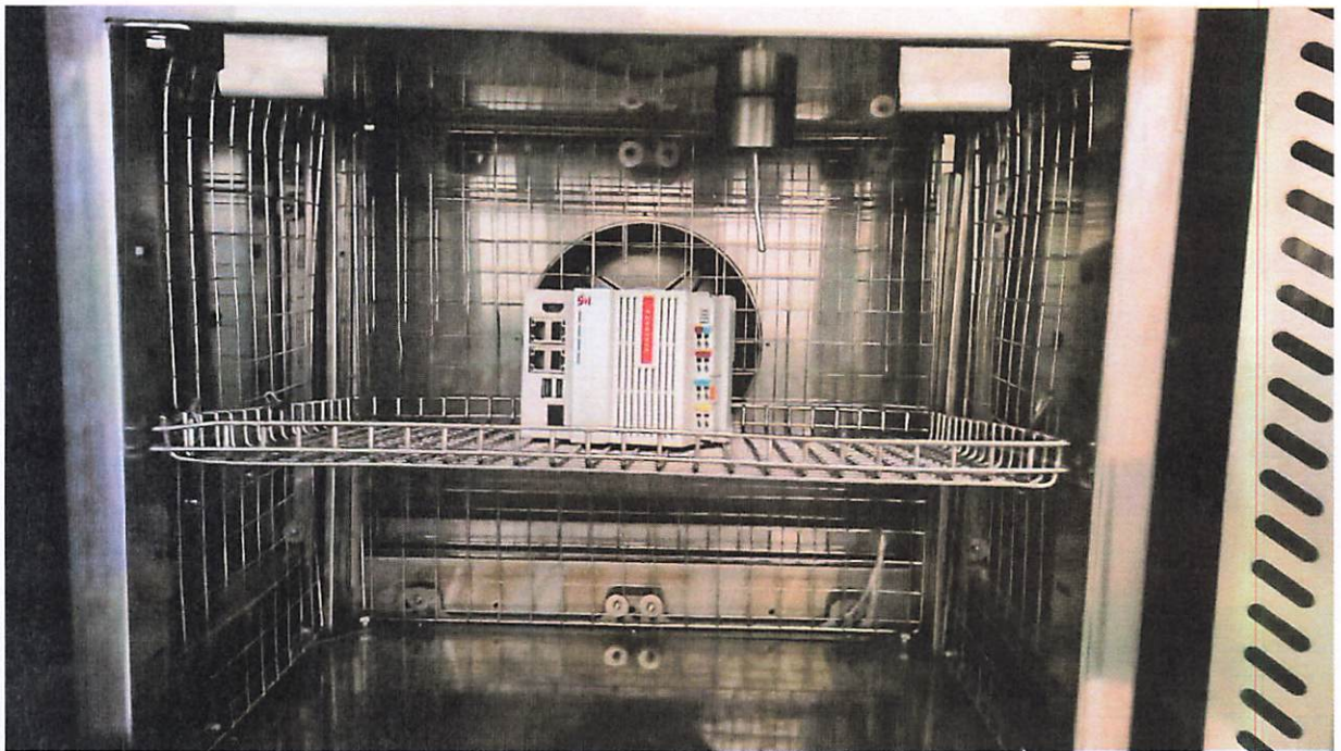
图2: 样品温度冲击试验照片
