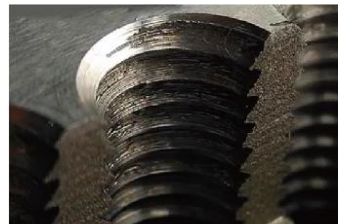
Other ER Tapping Chuck 普通ER刀柄攻牙加工效果
