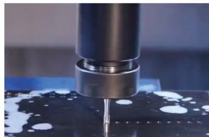
Other ER Tapping Chuck 普通ER刀柄刚性攻牙
