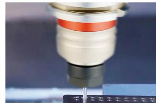
DEREK VER Split Synch Tapping Chuck 德克VER分体式微补偿刀柄攻牙
