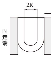
温度20°C的条件下，让管子弯曲成U字形，一端固定，另一端慢慢靠近，管子发生弯折，变扁等时测定的2R。
