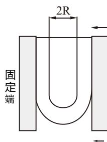
温度20°C的条件下，让管子弯曲成U字形，一端固定，另一端慢慢靠近，管子发生弯折，变扁等时测定的2R。
