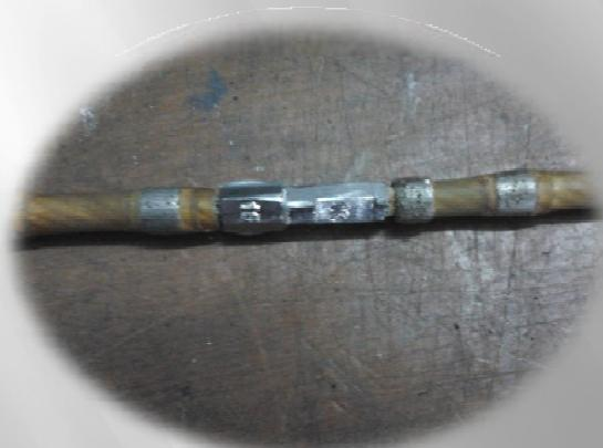
连接绳锯时，用切割轮切断绳锯以获得整齐的断口，不要用剪子剪断，否则断口不规则不利于接绳。
