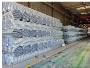
材质 Material 镀锌管以碳钢Q235为基材,表面经镀锌处理,分为热镀锌和电镀锌两种工艺。热镀锌层较厚 (60~150μm),耐腐蚀性强;电镀锌层较薄(5~30μm),表面光滑但防护性较弱。
