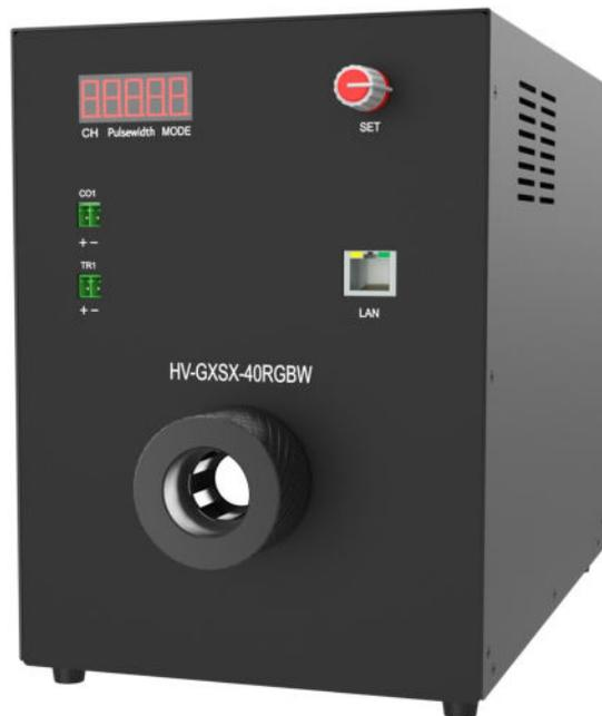
**【HV-GXSX-40RGBW】**是我司根据客户要求定制的 100KHz RGBW 数字频闪光纤点光源,可通过上位机灵活选择红、绿或 红、绿、蓝或红、绿、蓝、白的编组时序切换功能,可为机器视觉检测提供 R、G、B、W 四色光源高速时序切换的工作方案。具备内部触发工作模式,可同步输出相机同步型号,方便用户在没有外部同步型号源的情况下完成高精度同步抓拍;可通过以太网接口与计算机连接,进行远程控制,提供 0~999uS 的脉宽调节方式,最小调节单位 1uS,最大占空比 50%;最大有效外触发频率 100KHz/每通道,同步响应速度小于 400nS。整机设计具有空气对流通道的,采用热管强迫风冷方式散热,保证电子元器件有良好的散热效果,能更好的延长使用寿命。面板上有 5 位高清晰数码管,采用编码器选择功能及参数,显示信息完整,方便用户更好地操作。
