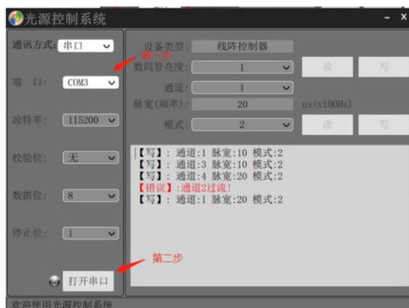
连接成功后，连接指示灯变为绿色，并且上位机软件自动识别设备类型
