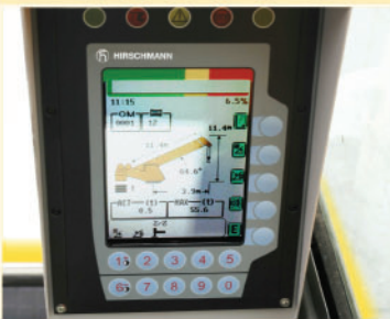
力矩限制器 LMI 彩色液晶的力矩限制显示所有重要操作信息。 Color LCD screen showing all important operating information.
