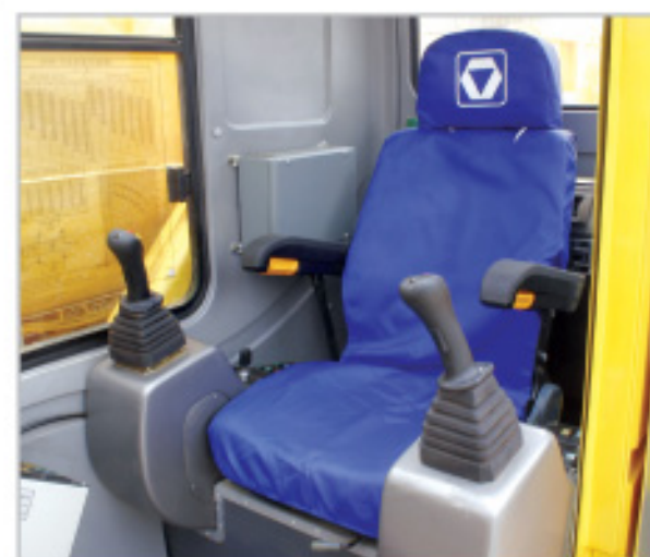
先导操纵系统 Hydraulic pilot control system
