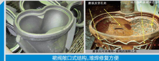
裙阀敞口式结构，堆焊修复方便
