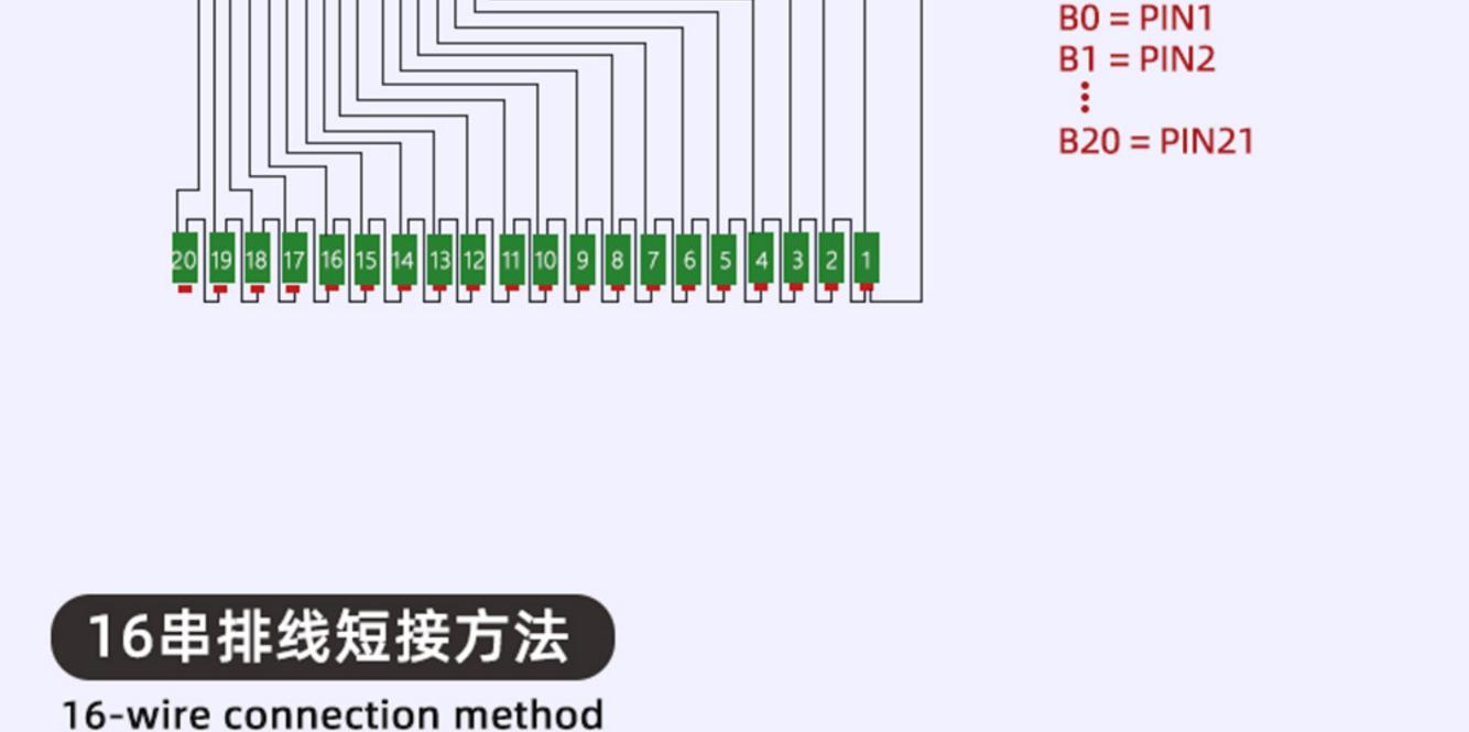
从板子上面B0位置开始接线即排线第一根排线开始,第一根线接第一串负
