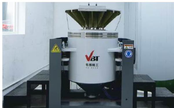
Камера для вибрационных испытаний Хорошо спроектированный динамический каркас круга, с более высокой частотой осевого резонанса ступени
