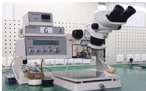
Машина для скрепления золотой проволоки Монтаж эвтектической матрицы в среде формовочного газа. Эпоксидная матрица для золота и серебра
