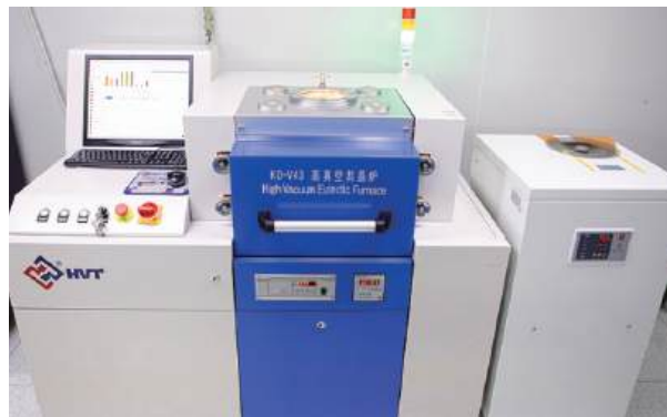
Эвтектическая печь высокого вакуума Доля пустот при сварке изделий <3%
