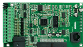
Control motherboard 控制主板
