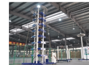
陡坡冲击电压试验 Steep-front impulse voltage test
