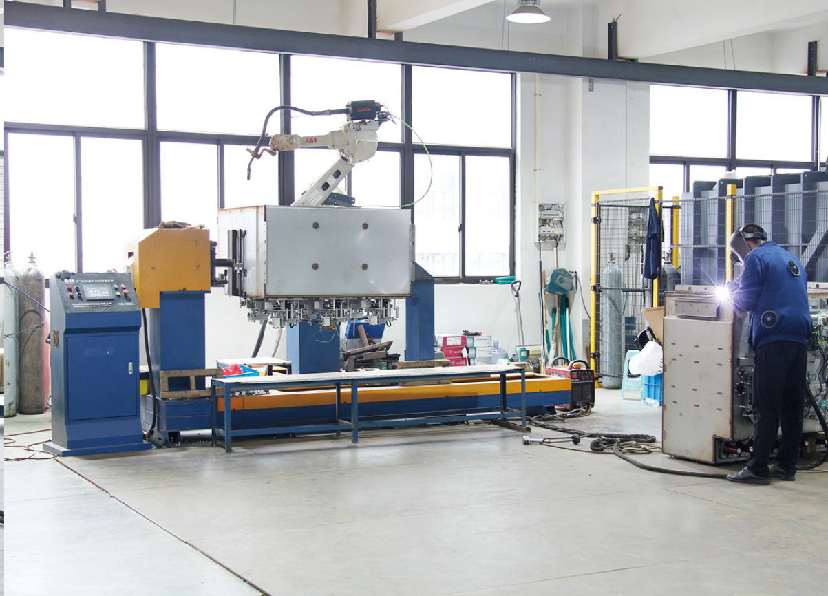
| 机器人焊接 Robot welding
