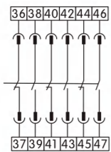
III: Tres contactos normalmente abiertos y tres normalmente cerrados
