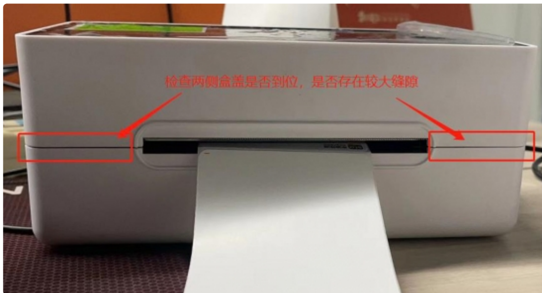
检查胶辊轴套是否脱出
