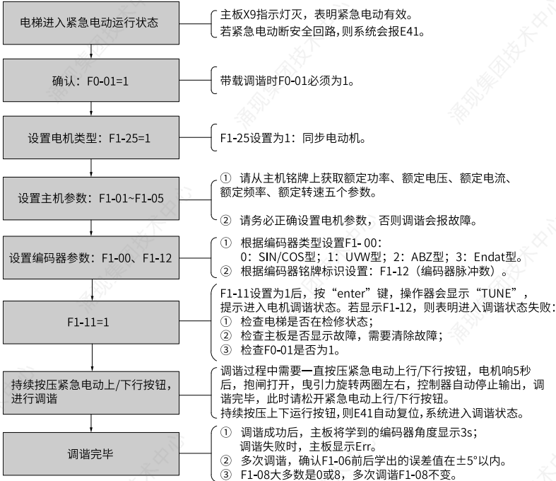
图17-1 同步机带载调谐
