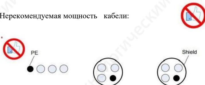
Рисунок А-3 Поперечное сечение нерекомендуемых экранированных кабелей
