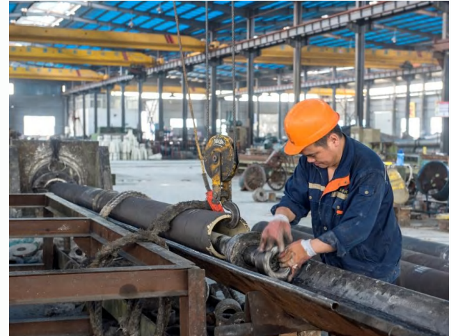
Chain cold drawing machine (OD : 6 - 630mm, WT: 1-50mm)
