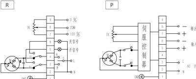
图2 110/220VAC 带电位器输出型
