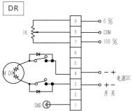
图5 直流带电位器输出型
