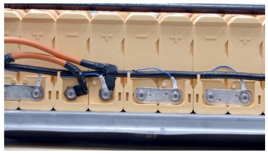
5.2 Immobilize the voltage collection wire into wire harness groove. (将电压采集线卡到固定线束卡槽上)。
