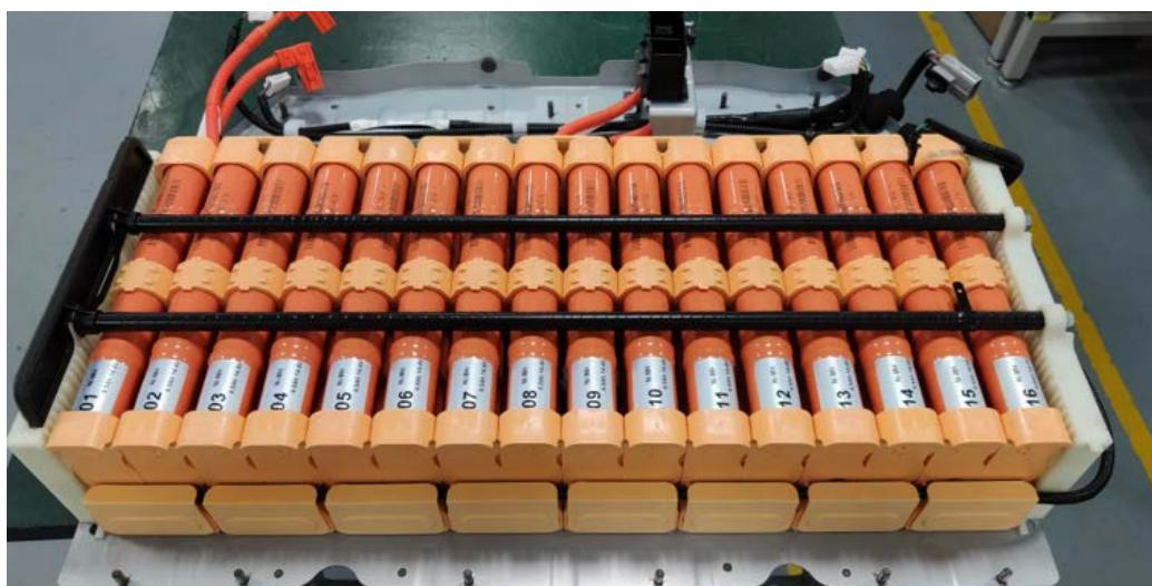
9. (安装电压采集卡支架、整理安装原车温度、电压采集线束 )。
