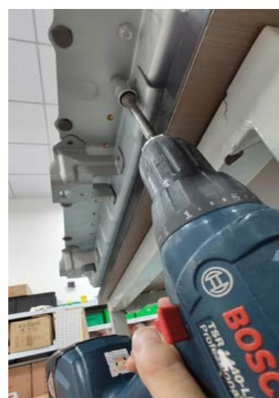
7. 将 4 根电池支架的侧板螺丝拧紧固定。
