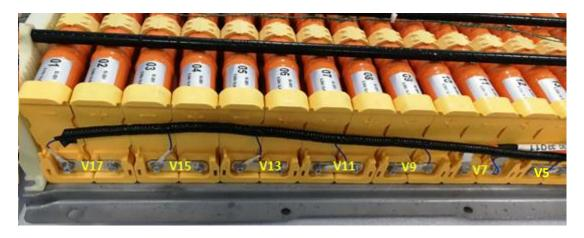
5.2 Immobilize the voltage collection wire into wiring harness groove. (将电压采集线卡到固定线束卡槽上)。
